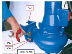
Fig. 14: Montage de la griffe pour guidage par 2 barres
